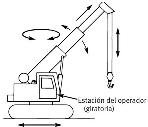
NOTA GENERAL: La pluma puede tener una estructura de pluma de base compuesta por secciones (superior e inferior). Entre estas, o más allá de ellas, pueden agregarse secciones adicionales para aumentar su longitud, o puede consistir en una pluma de base en la que una o más extensiones telescópicas se despliegan para obtener mayor longitud.
