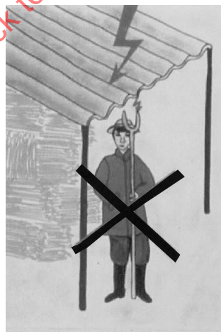
Figure 4 – Inadéquation des structures métalliques non reliées à la terre
