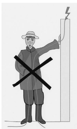
Figure 5 – Electrification par tension de toucher
