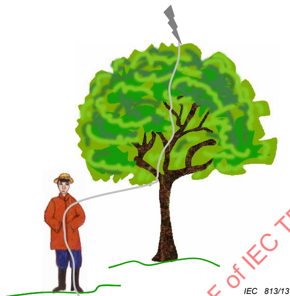
Figure 3 – Foudroiement par éclair latéral
